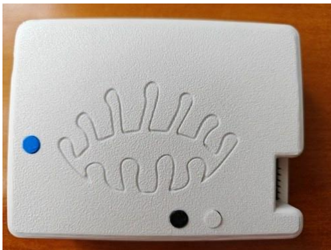
Face avant du capteur AMON : le bouton bleu (en haut), le bouton noir et le bouton blanc (à gauche).
