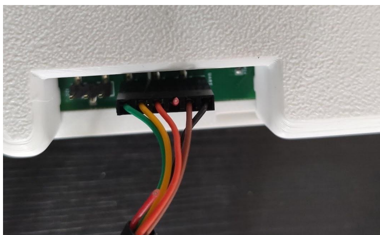
Branchement correct du câble sur le connecteur repéré « UART » : respectez cet ordre des fils.
